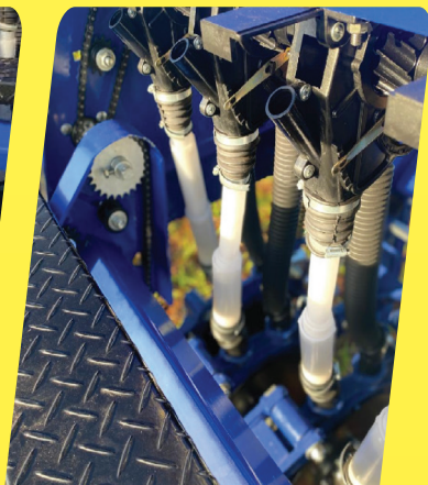
Dosador de semente através de rotor helicoidal
