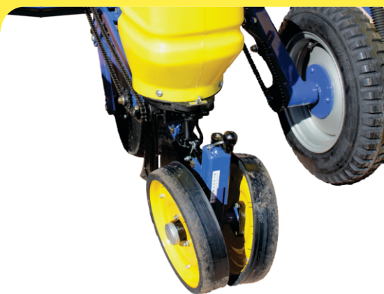
RODAS DE CONTROLE DE PROFUNDIDADE
